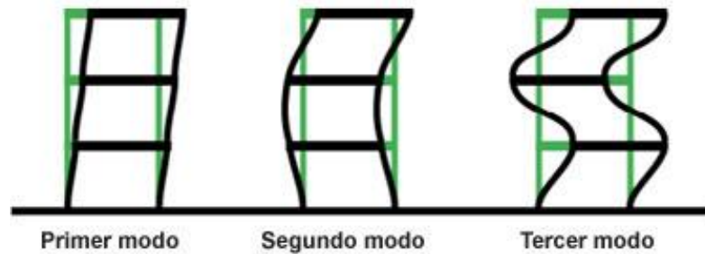
Figura 4. Modos de Vibración (Sísmica, 2014)
