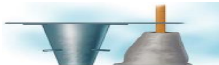
Figura 48: Ensayo de asentamiento
