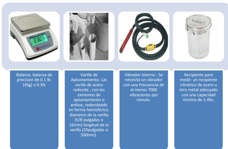
Figura 45: Equipos para la Norma ASTM C138
