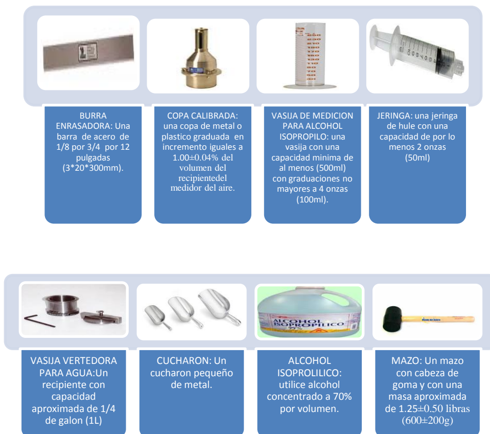
Figura 50: Equipo para la norma ASTM C173
