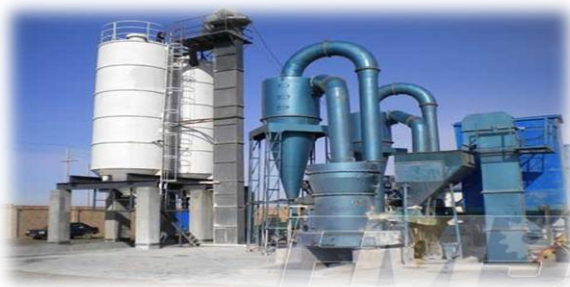
Figura 34: Silos verticales para cemento
