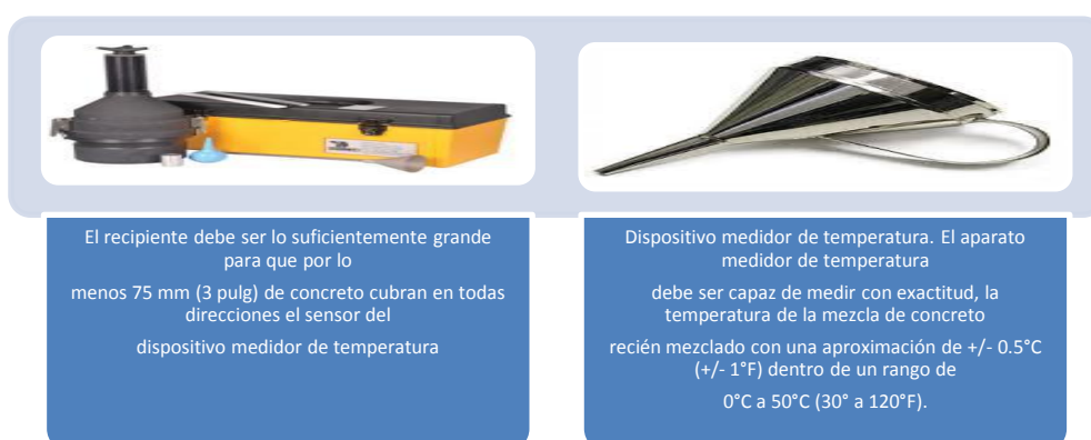
Figura 52: Equipo para la Norma ASTM C1064
