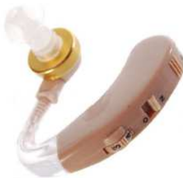
Figura 13: Audífono Digital con regulación de volumen Escala 1:3
