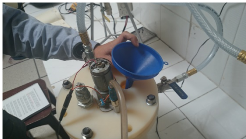
Figura 22: Ingreso de FES en polvo y agua nitrogenada (Uso embudo)
