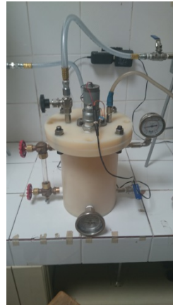
Figura 20: Reactor con todos sus elementos instalados
