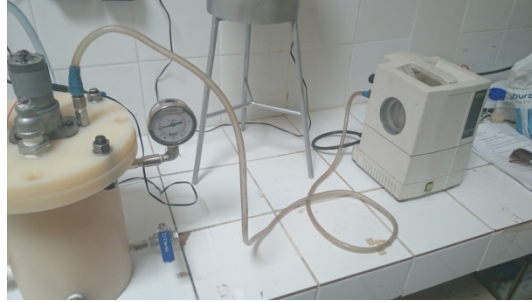
Figura 37: Fotografía de generación de vacío en Reactor
