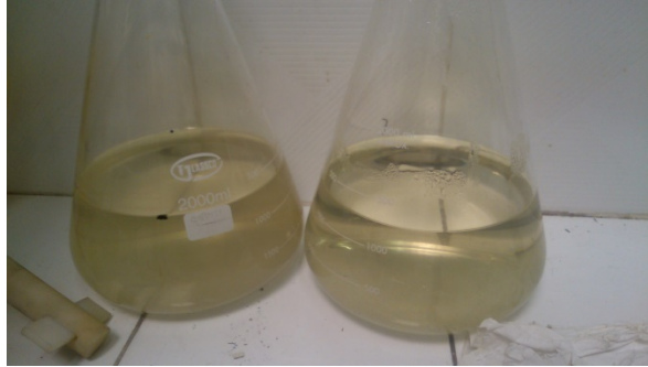
Figura 40: Solución de CMC cuando el químico (polvo) se quemó. Observar la turbidez de la solución y la suciedad.
