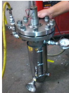
Figura 33: Fotografía Prueba Neumática Recipiente CMC
