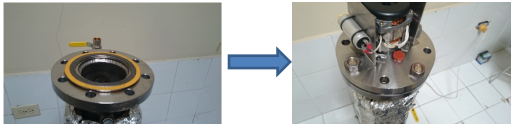
Figura 5: Cerrado de tapa bridada en recipiente CMC
