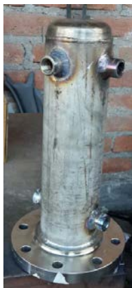
Figura 31: Soldadura de recipiente CMC (Final proceso de Fabricación)
