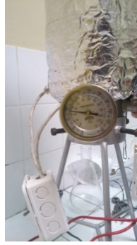
Figura 9: Termómetro que indica el aumento de temperatura de solución CMC
