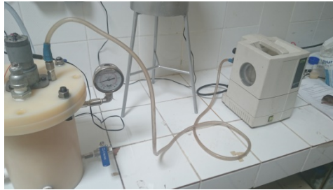
Figura 19: Conexión de bomba de vacío al Reactor
