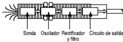
Figura 2.2. Sensor capacitivo de proximidad
