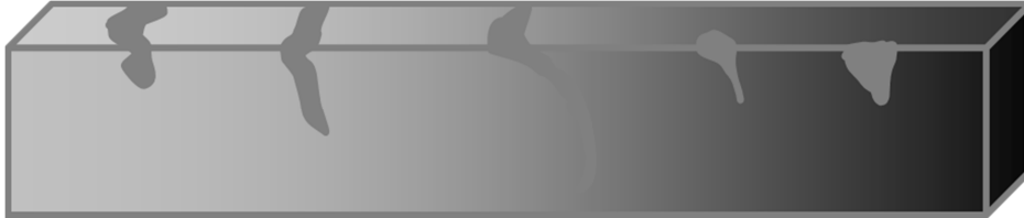
Figura 2.2 Discontinuidades superficiales Fuente: Código ASME sección V
