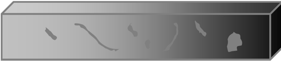
Figura 2.3 Discontinuidades subsuperficiales Fuente: Código ASME sección V
