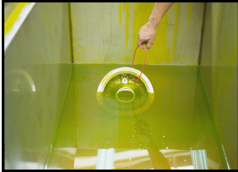
Figura 2.13 aplicación del penetrante por inmersión Fuente: Norma ASTM E 165-95.
