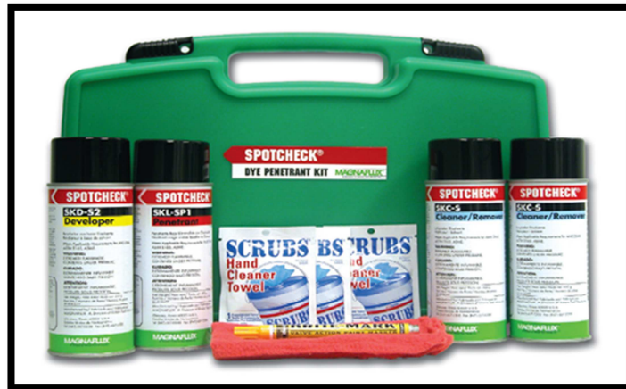
Figura 2.1 Equipo portátil Fuente: Art. 6 del código ASME Sec. V
