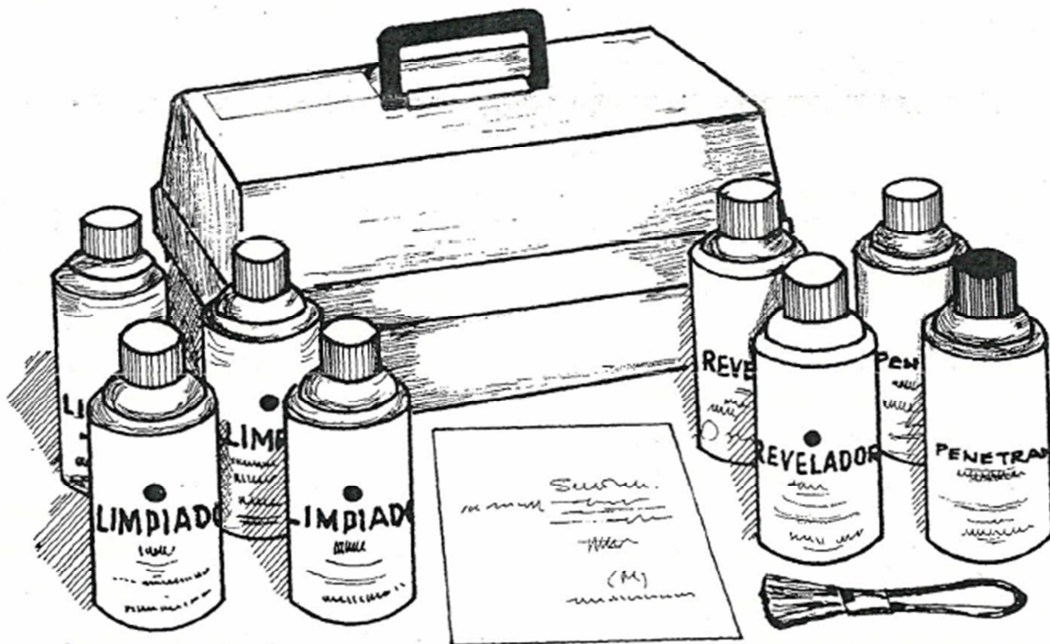
Figura 3.2.1.3 Equipo portátil para la inspección por líquidos penetrantes
