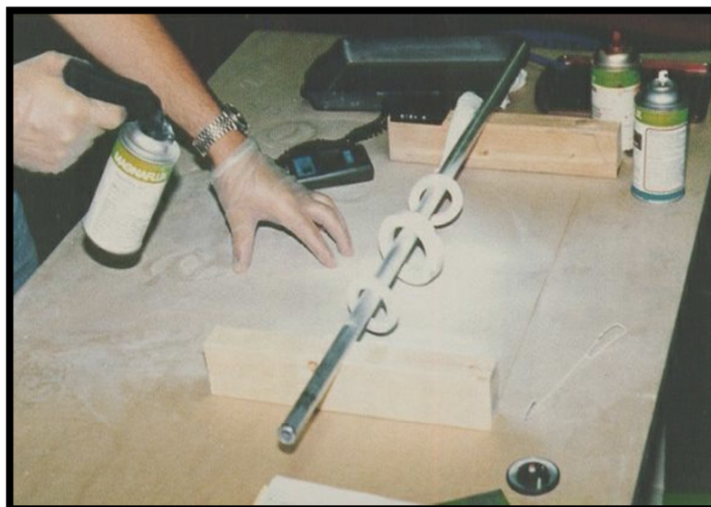
Figura 2.16 aplicación del revelador Fuente: Norma ASTM E 165.
