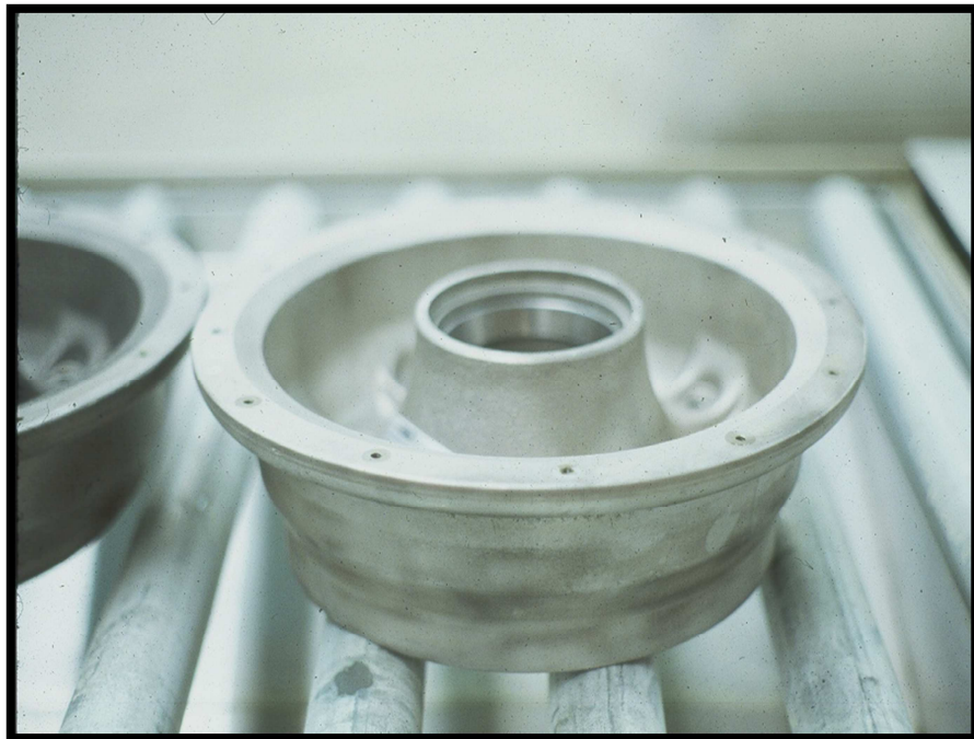
Figura 2.12 primera etapa de secado del componente Fuente: Norma ASTM E 165-95
