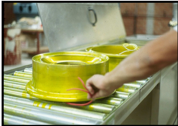
Figura 2.14 Tiempo de penetración Fuente: Norma ASTM E 165-95.
