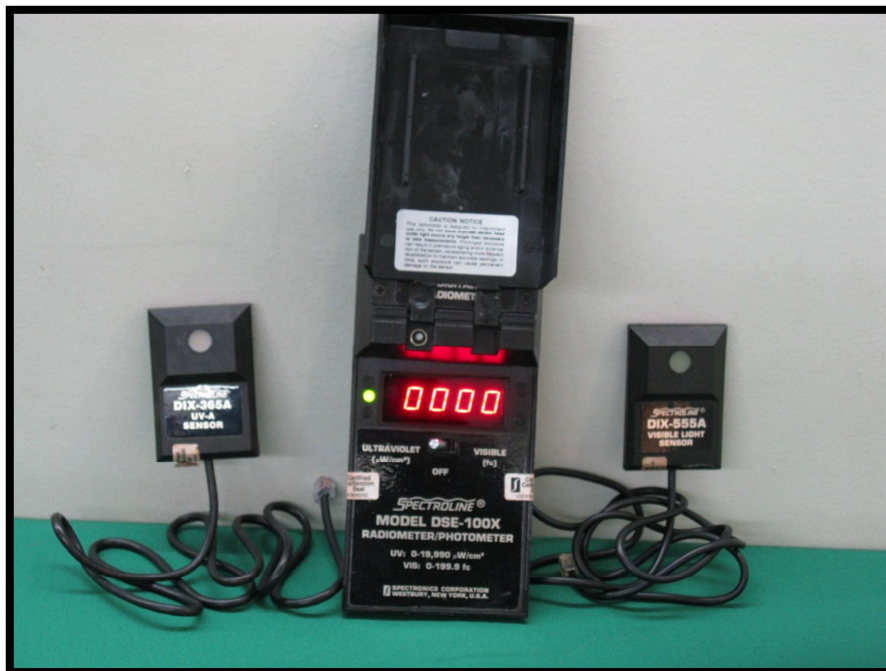
Figura 2.11 Medidor de intensidad Fuente: Norma ASTM E 1444
