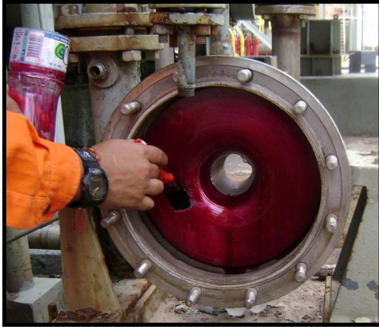
Figura 2.6 penetrante visible o contrastante Fuente: Norma ASTM E 165-02.
