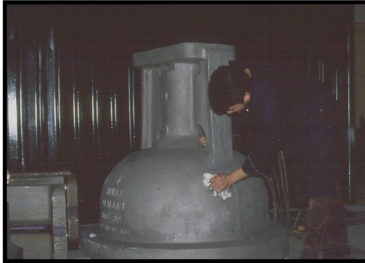
Figura 2.15 Remoción del exceso de penetrante Fuente: Código ASME Secc. V Ed. 2007.
