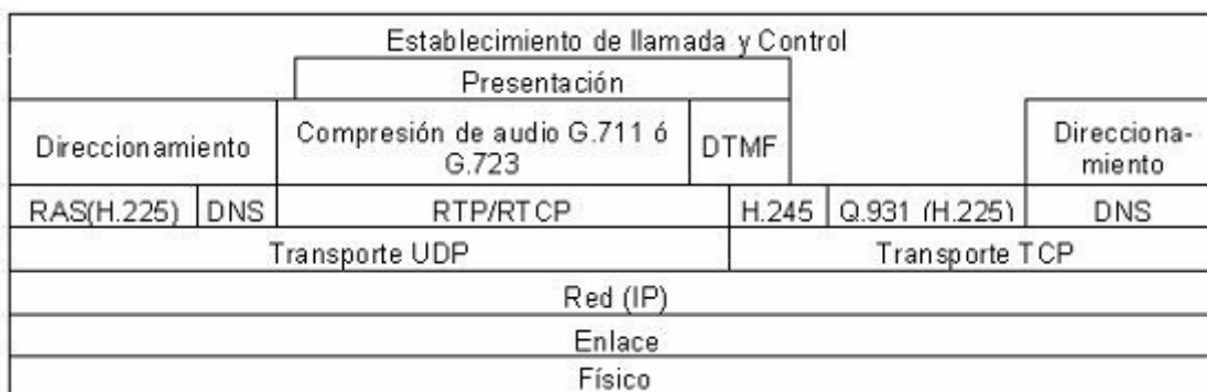
Figura 2.17: Pila de protocolos en VoIP
