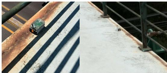
**Figura. 15. Nodos sensores desplegados.**
