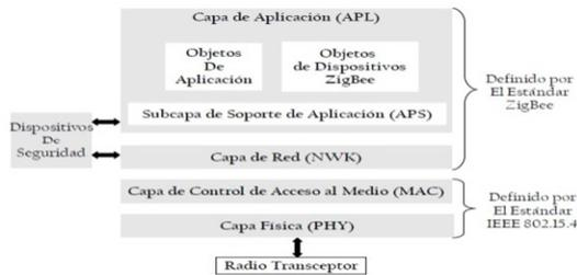
**Figura.2. Capa modelo del protocolo inalámbrico ZigBee.**
