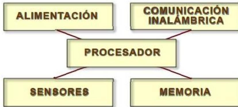
**Figura. 9. Arquitectura de un nodo inalámbrico.**
