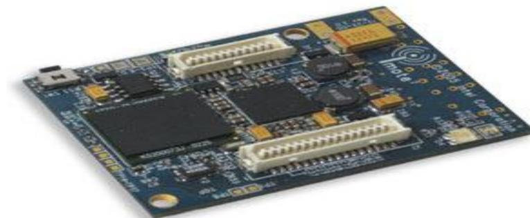
**Figura. 62. Plataforma Imote2 (Intel mote 2).**
