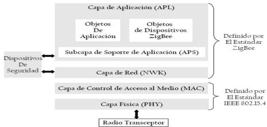
**Figura.21. Capa modelo del protocolo inalámbrico ZigBee.**
