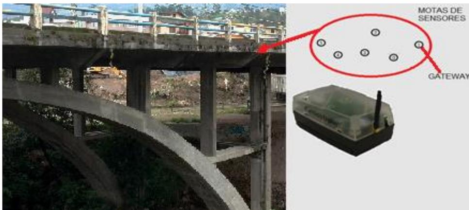
**Figura. 34. Dispositivos de sensores inalámbricos Crossbow para sensar vibraciones.**
