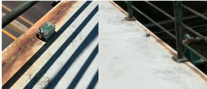
**Figura. 73. Nodos sensores desplegados.**
