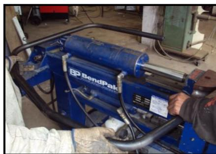
**Figura 6.16:** Dobladora de tubos de tipo hidráulica.
