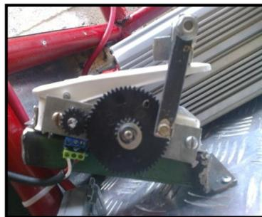
**Figura 6.49:** Instalación-sistema de aceleración.
