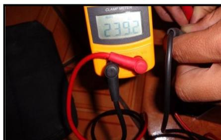
**Figura 6.55:** Voltaje en la Entrada al variador.
