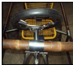
**Figura 6.30:** Regulación altura volante de la dirección.
