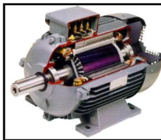
**Figura 2.16:** Motores eléctricos.
