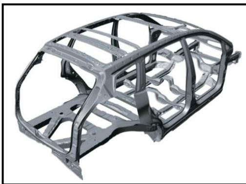
**Figura 2.8:** Chasis Tipo Monocasco
