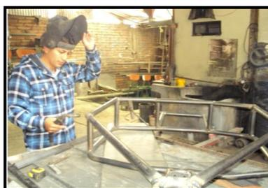
**Figura 6.18:** Punteado de la estructura. Proceso de soldadura de tipo MIG.
