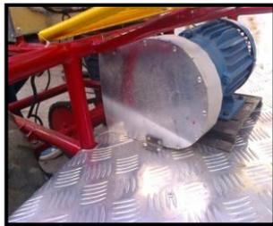
**Figura 6.43:** Protecciones para el motor.
