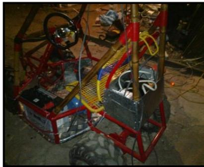
**Figura 6.46:** Montaje batería Bosh - S3
