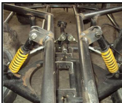
**Figura 6.20:** Montaje suspensión delantera del vehículo.
