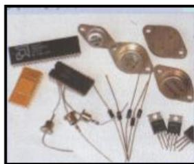
**Figura 3.3:** Componentes electrónicos fabricados en silicio.
