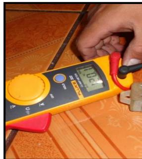
**Figura 6.54:** Valor voltaje en el transformador.
