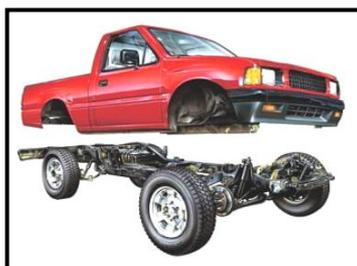
**Figura 2.2:** Conjunto de carrocería (Chasis independiente).
