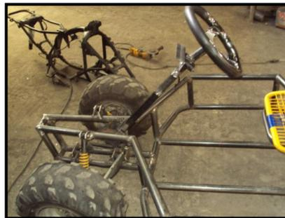
**Figura 6.25:** Sistema de dirección de tipo mecánica.
