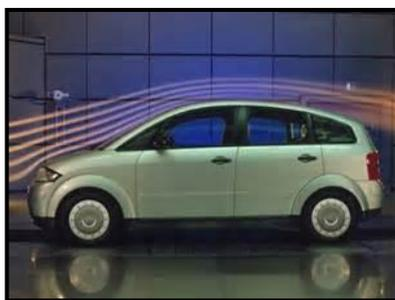
**Figura 4.11:** Carga por resistencia del aire frontal.
