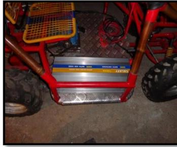
**Figura 6.47:** Instalación-inversor DC/AC.
