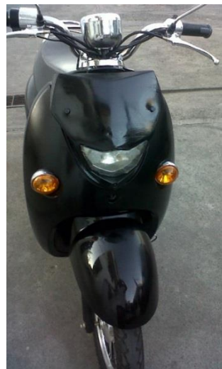
Figura 27 Colocación del carenado.
