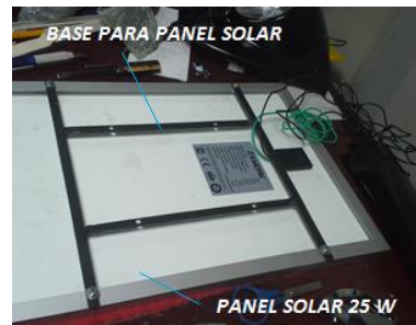
Figura 22 Base para Panel Solar.
