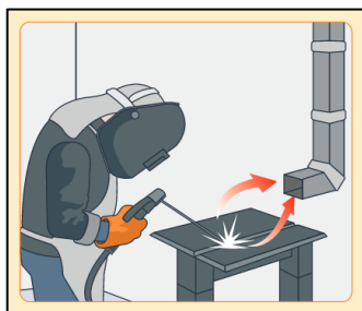
Figura 4. 49: Riesgo de accidente de soldadura por falta de Ventilación
