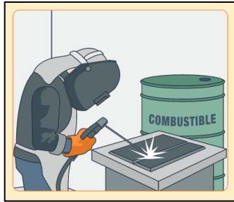
Figura 4. 48: Riesgo de accidente de soldadura por encendido de combustible
