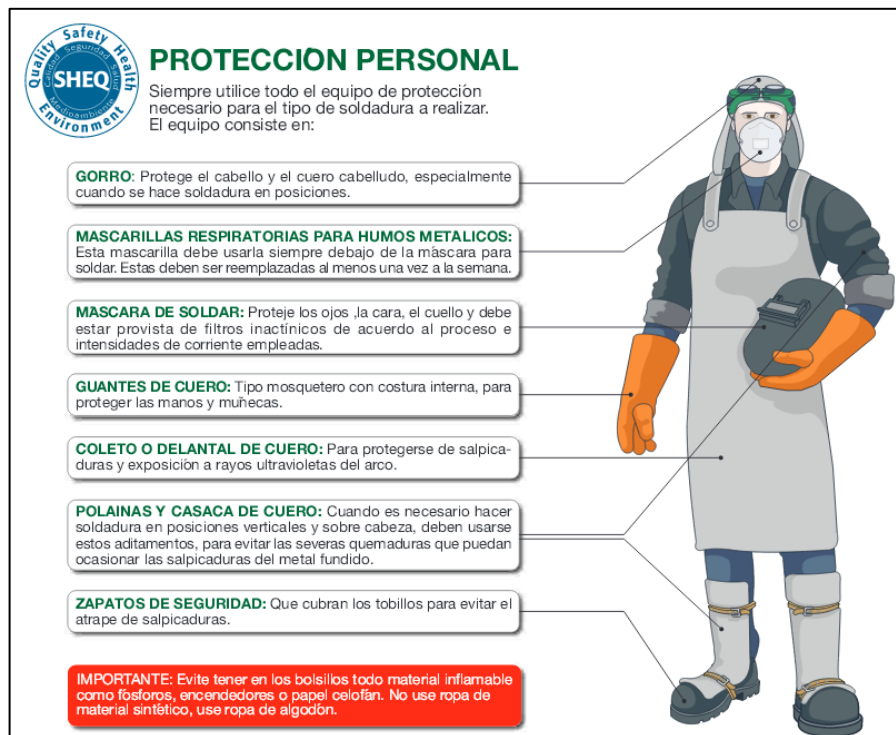
Figura 4. 52: Indumentaria de Soldadura
