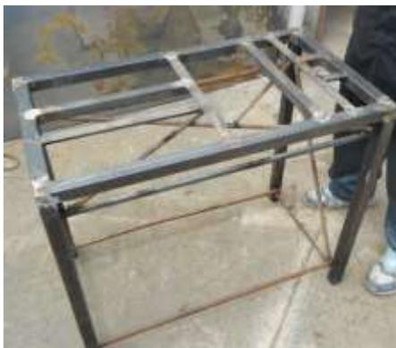
**Figura 3.18:** Corte y soldado de la estructura.
