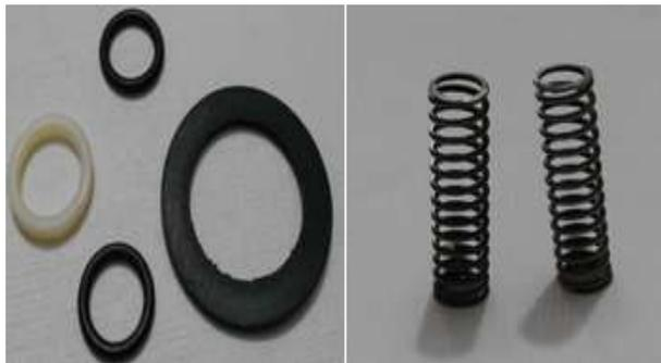
**Figura 3.21:** Elementos internos de la bomba.
