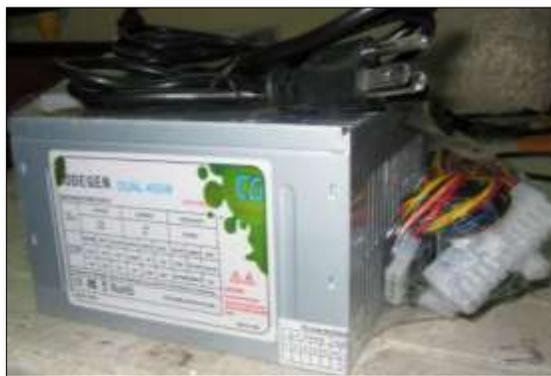
**Figura 3.43:** Fuente de pc con voltajes de 3v, 5v, 12v,-12v.
