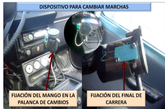
Figura 4: Encoder del embrague y final de carrera
