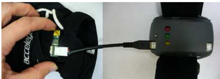
Figura. 2.10. Módulo inalámbrico del AcceleGlove [9]
