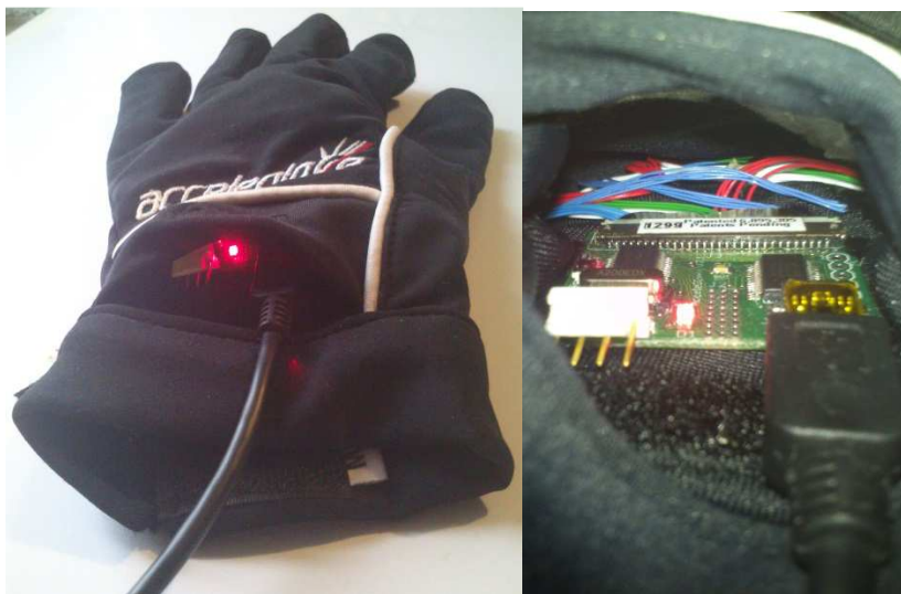
Figura. 4.1. Posición de la tarjeta electrónica del AcceleGlove [A]
