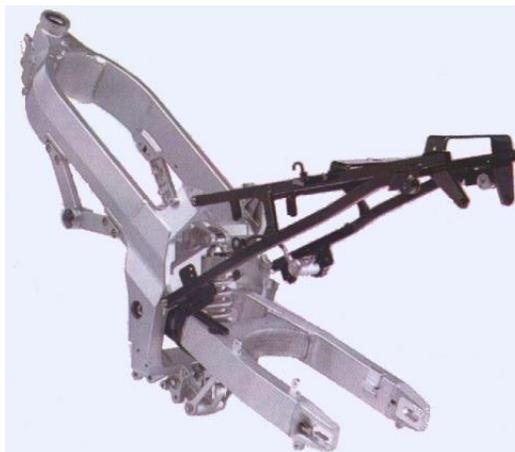
Figura 3.10 Chasis doble viga
