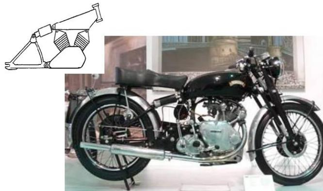
Figura 2.15 Chasis con motor estructural de las motocicletas Vincent
