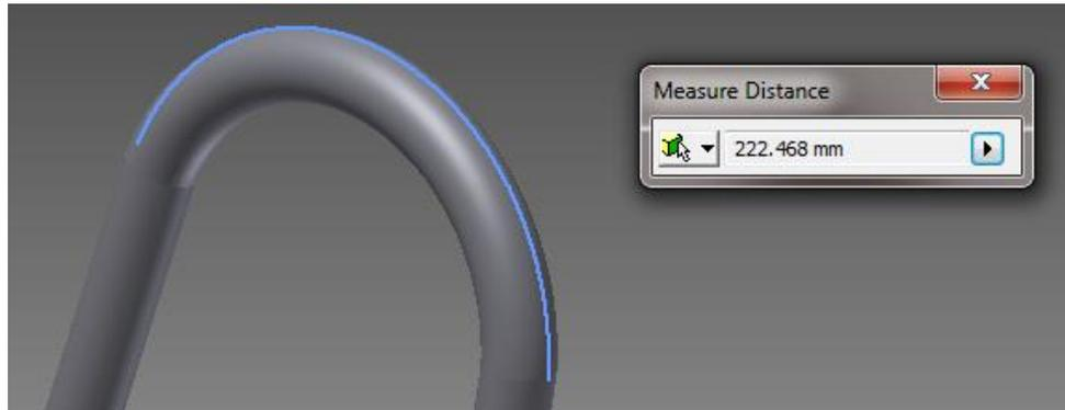
Figura 4.35 Longitud - espaldar del bastidor
