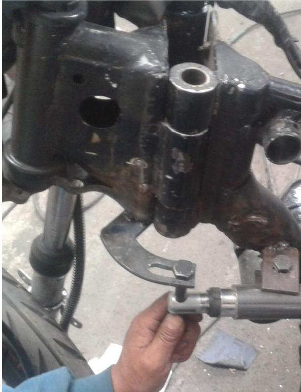
Figura 5.6 Bastidor instalado el mecanismo de plegado
