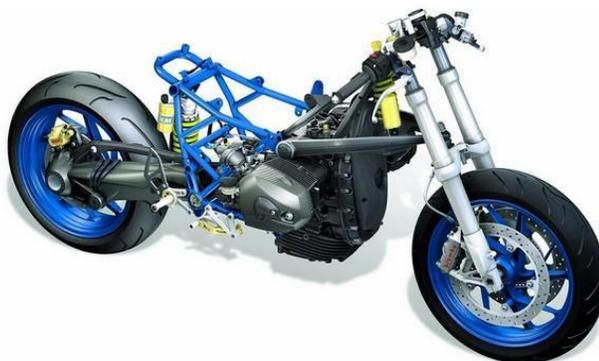
Figura 2.16 Bmw hp2 sport boxer con motor estructural
