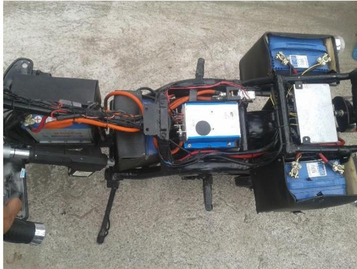
Figura 6.1 Ubicación de los elementos del sistema eléctrico motriz
