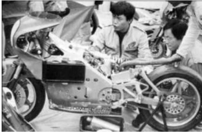
Figura 2.18 Honda NR 500, con chasis monocasco
