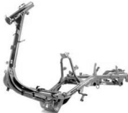
Figura 2.2 Chasis de simple cuna típico en scooters
