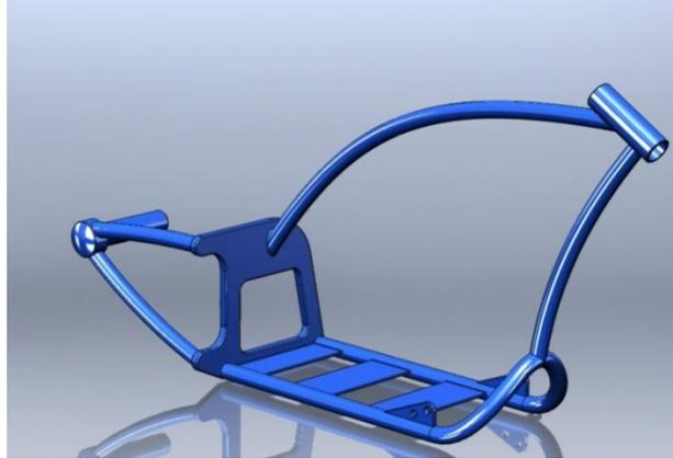
Figura 4.2 Modelo CAD chasis
