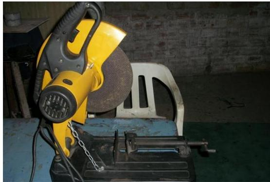
Figura 5.1 Herramienta para corte de tubos
