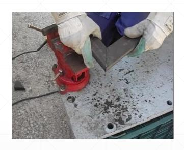
En las platinas que servirán de base para las baterías es necesario hacer un trabajo de biselado para que encajen correctamente como se muestra en la figura
