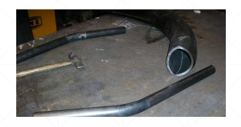
El tipo de corte es sobre medida del 0.5% de su longitud para evitar problemas por perdida de material en momento de corte como se muestra en la figura
