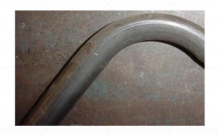
En la figura se muestra el diseño del bastidor que posee tubos con forma curva, para lo cual se procedió a doblarlos hasta obtener los resultados esperados en cada caso.
