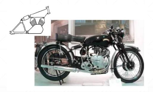
Esta forma de construir una motocicleta es la más adecuada si el motor es grande, y se basa en utilizar la rigidez del motor para conectar la pipa de dirección con el eje del basculante
