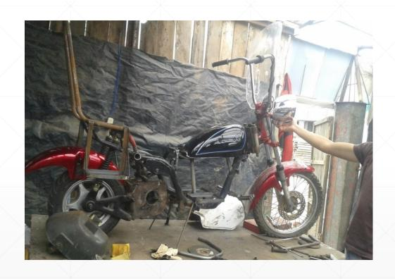
En la figura se muestra la primera apariencia que tomo el diseño montando algunos sistemas como suspensión, dirección y plegado
