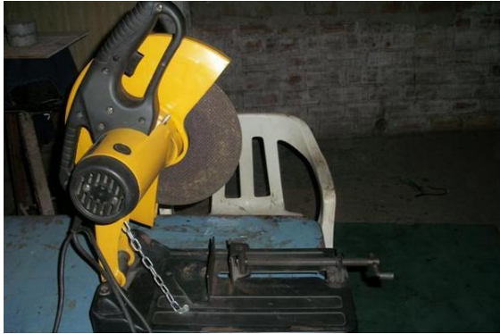
Figura 18 Herramienta para corte de tubos Autores: Arias, De La Cruz, Tutillo (2014).
