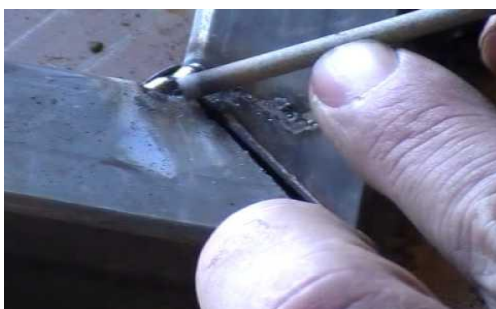
Figura 20 Unión de bases de batería Autores: Arias, De La Cruz, Tutillo (2014).
