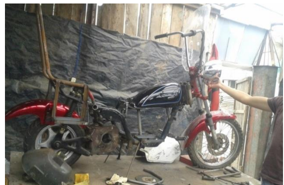
Figura 21 Bastidor con suspensión y dirección Autores: Arias, De La Cruz, Tutillo (2014).
