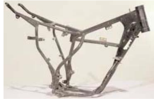
Figura 4 Chasis de simple cuna Fuente: (Bottpower, 2014)
