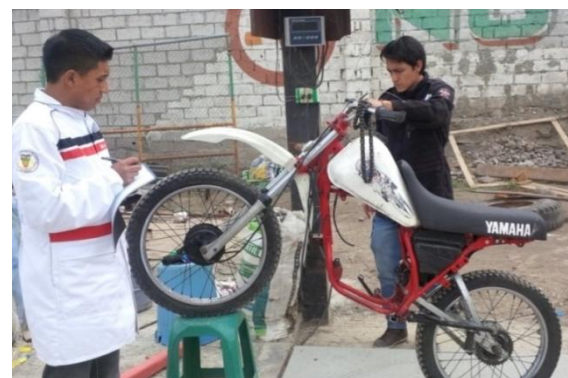
Figura 5 Chasis de simple cuna Autores: Arias, De La Cruz, Tutillo (2014)
