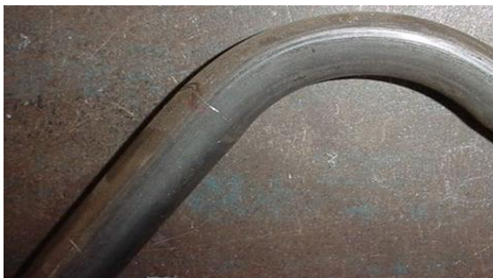
Figura 19 Tubo frontal del bastidor doblado Autores: Arias, De La Cruz, Tutillo (2014).
