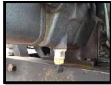
Figura 16: Instalación del sensor de temperatura agua motor
