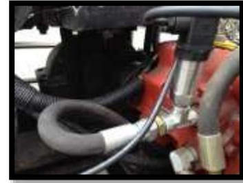
Figura 15: Implementación de los sensores de presión aceite hidráulico.
