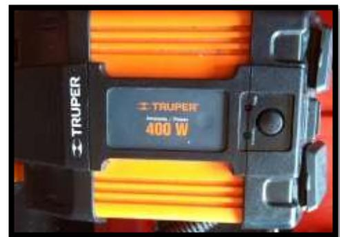
Figura 8: inversor de corriente
