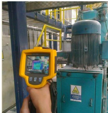
**Figura 1. 6: Cámara Foto térmica Fluke Ti 25**
