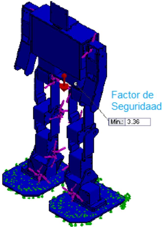
Finalmente en base a los resultados obtenidos en este análisis estático se concluye que la estructura resiste y no tiene fallos de seguridad estructural con el material asignado.
