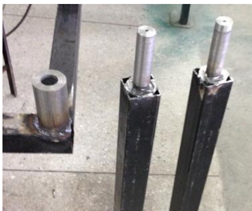
Figura 39. Pasadores soldados a las patas de la estructura
