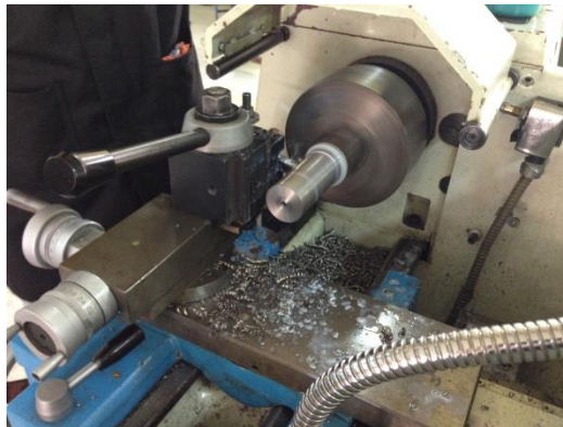
Figura 37. Fabricación del pasador
