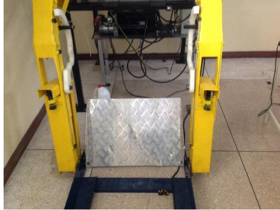
Figura 87. Plataforma de conexión plataforma del elevador – estructura
