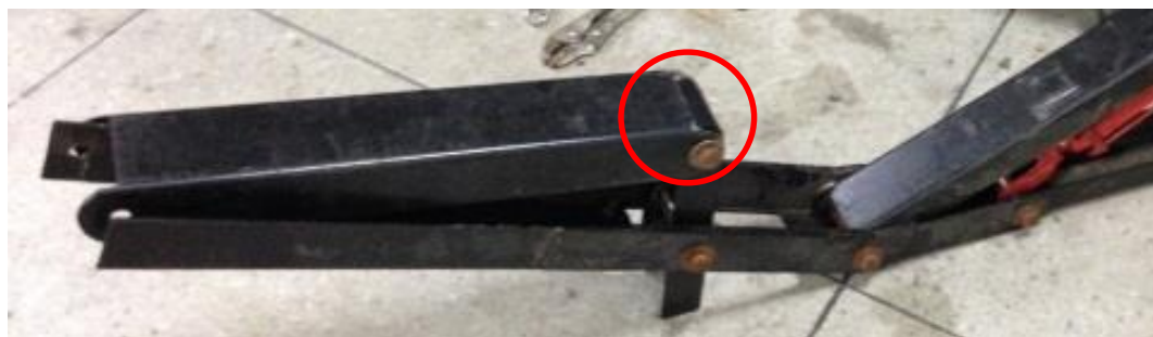
Figura 45. Implementación del rodillo de duralon en el brazo
