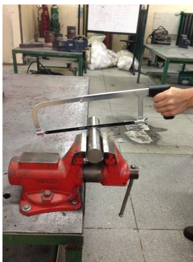
Figura 35. Corte del tocho de acero de transmisión para los pasadores
