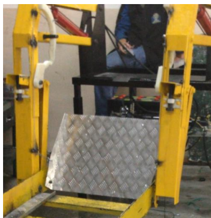
Figura 124. Implementación final del mecanismo leva-seguidor
