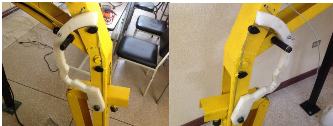
Figura 123. Levas implementadas en los brazos
