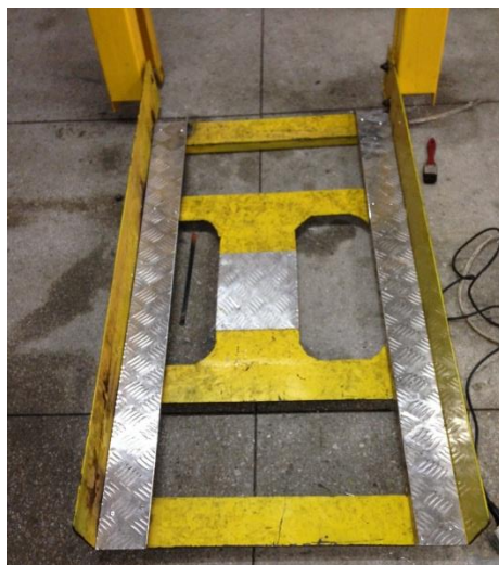
Figura 51. Plataforma con rieles de tol corrugado
