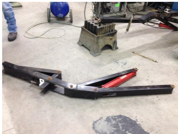
Figura 41. Brazo con apertura de la manguera del pistón limitada
