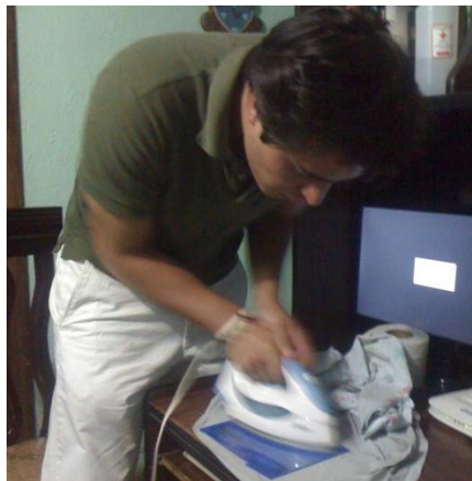
Figura 133. Proceso de transferencia del diseño a la placa
