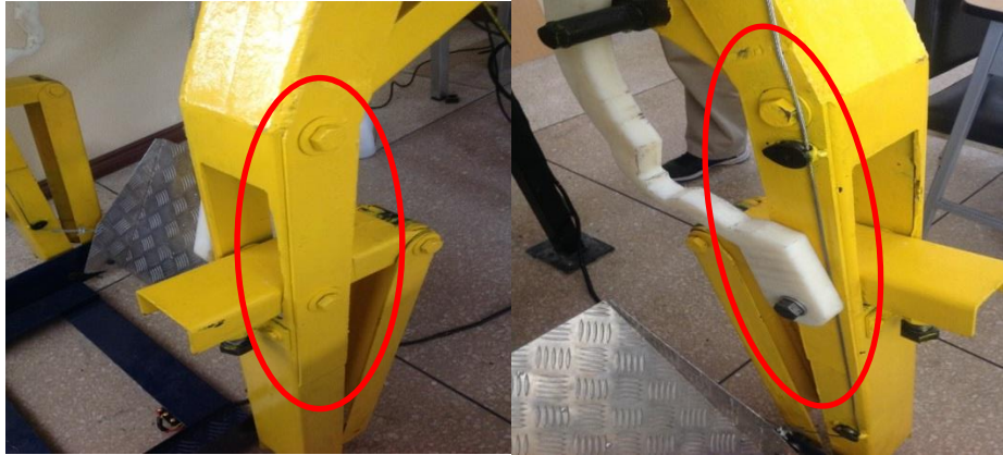
Figura 146. Refuerzos para no tener falla por fatiga.
