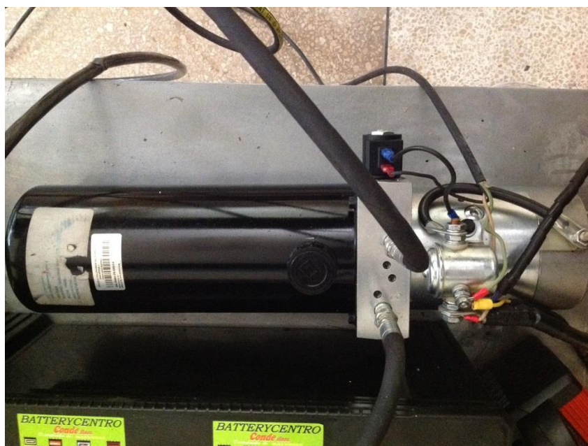
Figura 131. Implementación bomba hidráulica
