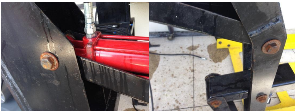
Figura 46. Fugas hidráulicas en los brazos
