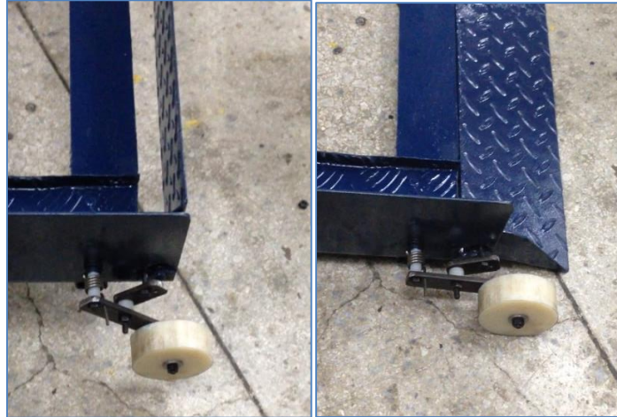
Figura 126. Funcionamiento del mecanismo de seguridad
