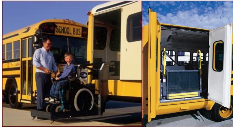
Figura 10. Elevador de movimiento paralelo instalado en un autobús escolar
