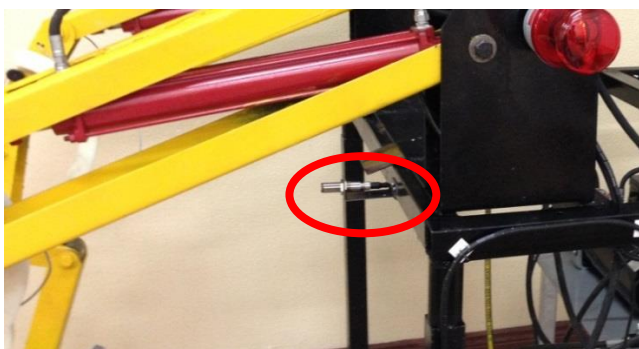
Figura 94. Sensor fotoeléctrico para detectar a la plataforma cuando se encuentre a la misma altura de la estructura
