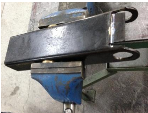
Figura 44. Modificaciones realizadas para la implementación del rodillo de duralon
