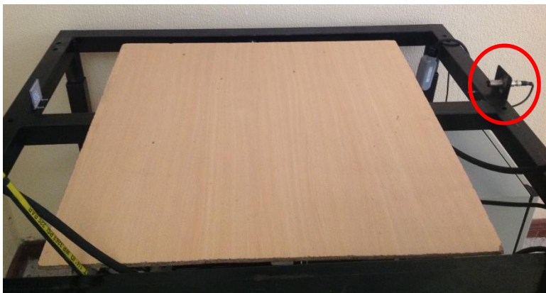
Figura 95. Sensor fotoeléctrico para detectar salida de silla de ruedas
