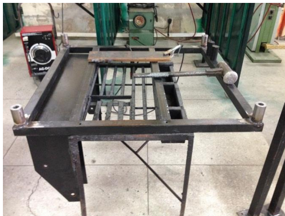
Figura 38. Estructura soldada las camisas de los pasadores
