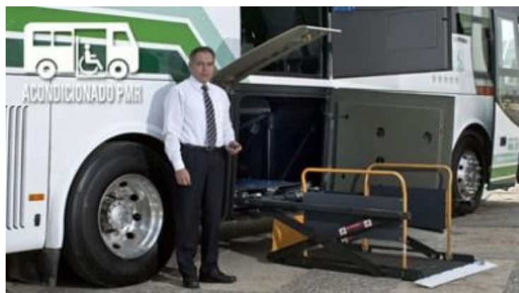
Figura 3. Mecanismo de tijeras para bus
