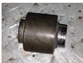
Figura 118. Bocín para la unión entre la plataforma y los brazos
