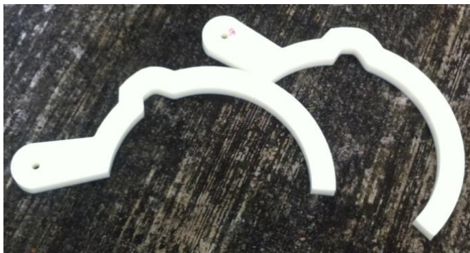
Figura 122. Levas después del maquinado en fresa CNC
