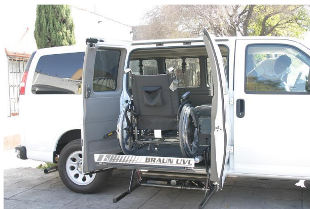
Figura 2. Mecanismo de tijeras para furgoneta tipo Van
