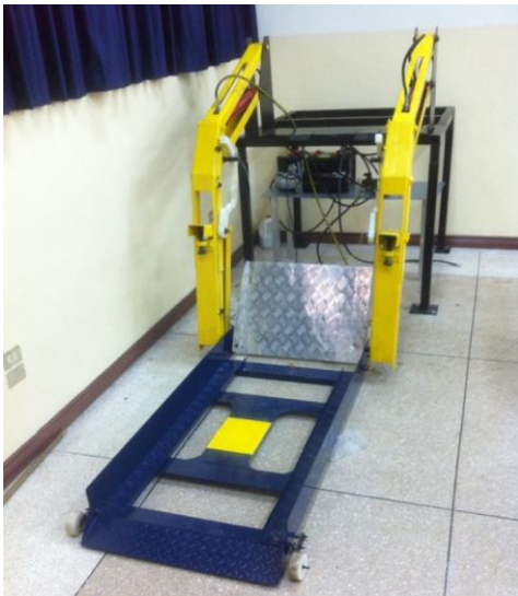
Figura 17. Implementación final del elevador de silla de ruedas.
