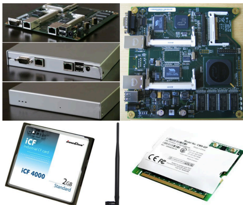
Figura. 49 Tarjeta Alix2d2 con sus elementos
