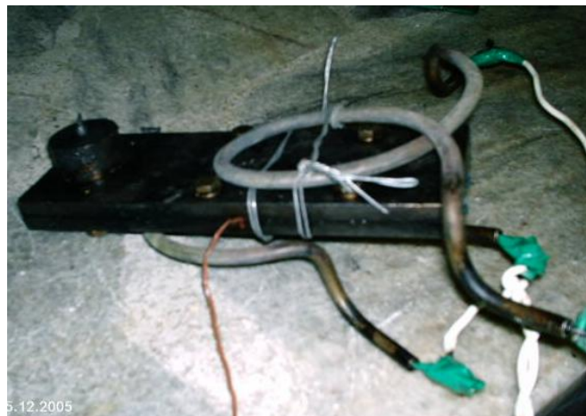
Figura 5.4. Matriz adicional con resistencias eléctricas.
