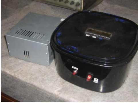
Figura 4.9 Sistema de control de temperatura.
