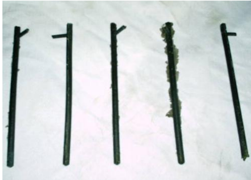
Figura 5.6. Probetas para tracción (probetas alargadas).
