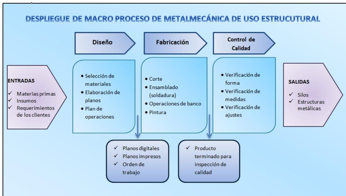
*Gráfico 22 Macro proceso de producción de metalmecánica de uso estructural*
