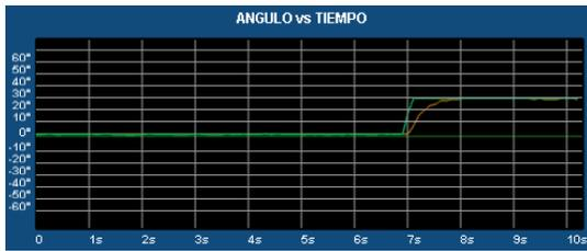
**Figura 12: Respuesta del controlador PID con las constantes teóricas**
