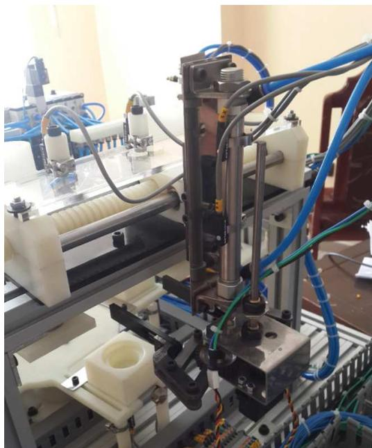
**Figura 112 Montaje de la celda de ensamble de discos (Etapa 3)**
