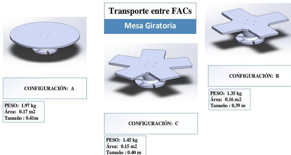
Figura 17. Planteamiento de modelos de solución a la celda de transporte
