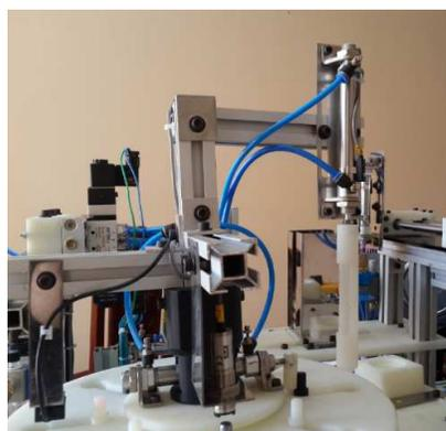
**Figura 105 Montaje de la celda de ensamble de ejes (Etapa 3)**
