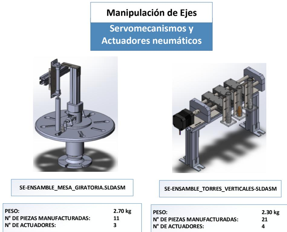
**Figura 29. Soluciones planteadas para la celda de ensamble de ejes**
