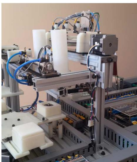
**Figura 108 Montaje de la celda de ensamble de discos (Etapa 1)**
