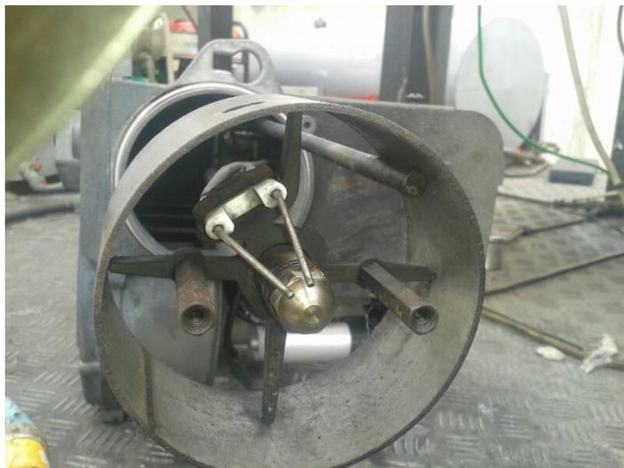
**Figura 16. Tobera y electrodos de un quemador a diesel**
