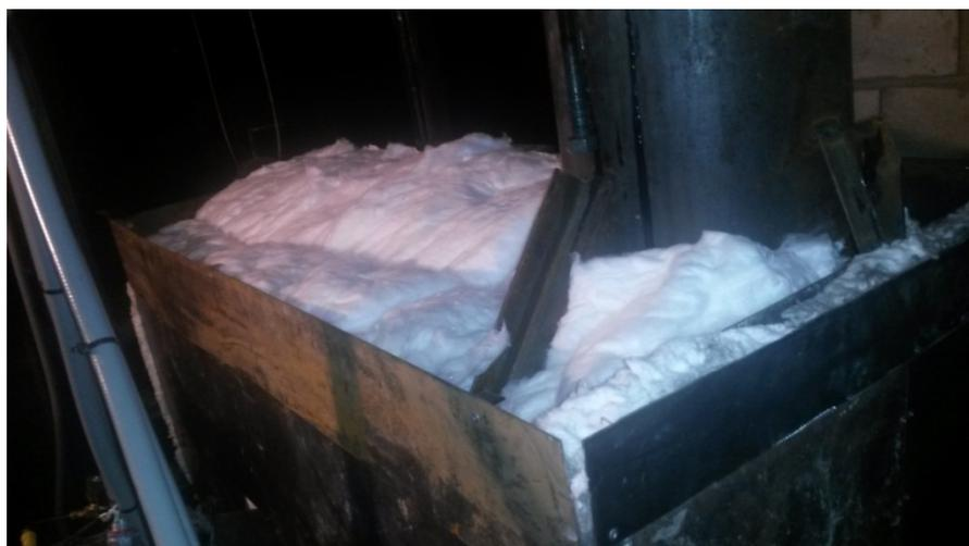
**Figura 81. Aislamiento térmico a la cúpula**
