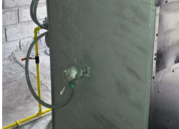
**Figura 35. Termocupla K en cámara de postcombustión**
