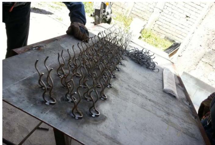
**Figura 3. Anclajes para sujeción de refractario**
