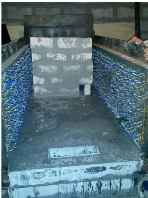
**Figura 5. Anclajes para sujeción de refractario con plástico**
