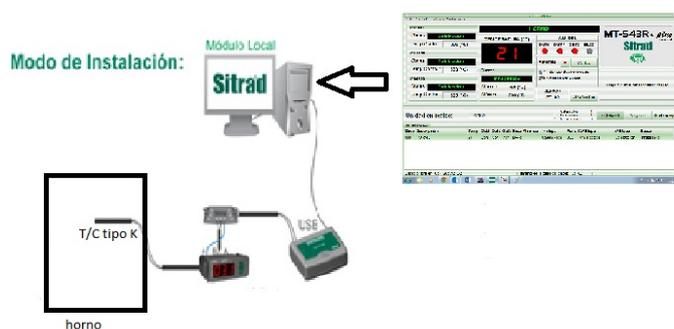
**Figura 57. Sitrad conectado al horno**
