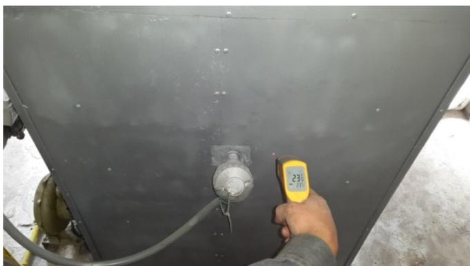
**Figura 95. Temperatura en recubrimiento de la cámara de postcombustión**
