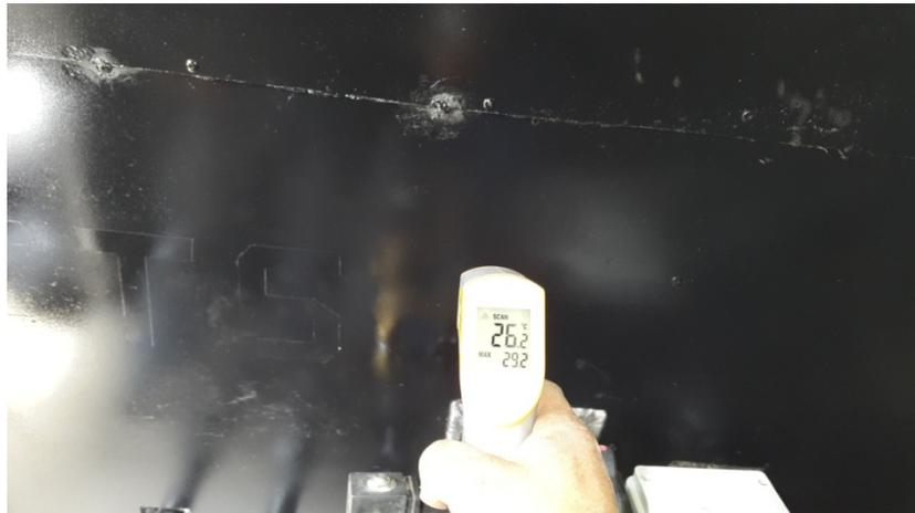
**Figura 96. Temperatura en recubrimiento de pared de quemadores**
