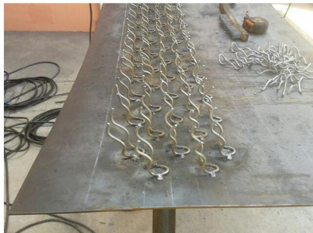
**Figura 70. Anclajes para refractario de las paredes**
