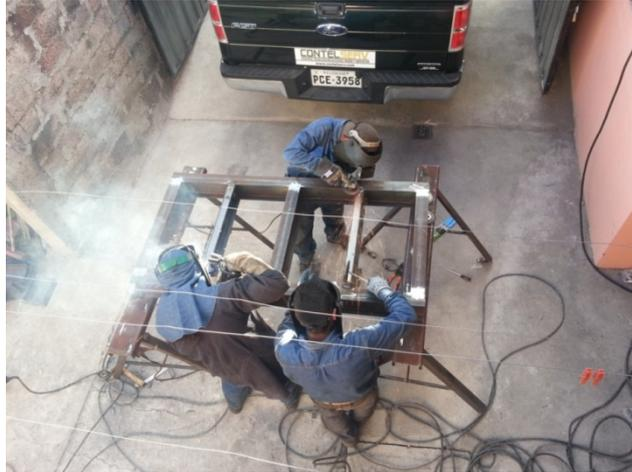
**Figura 69. Estructura para la base del horno crematorio de mascotas**
