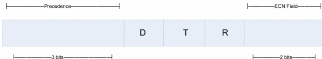
Figura 1.14. Bits del Campo Tipo de Servicio
