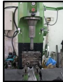
Figura 1. Rectificadora Vertical.
