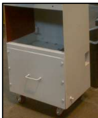
FIGURA 3.37. Estructura con pintura y llantas colocadas
