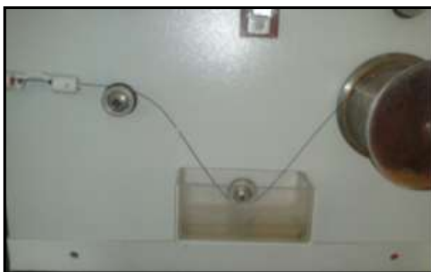
FIGURA 4.7. Sistema mecánico para prueba de continuidad
