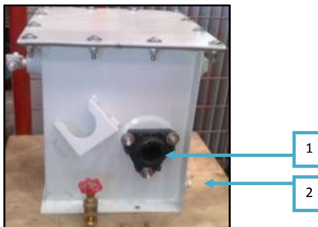
FIGURA 3.20. Cara lateral del transformador
