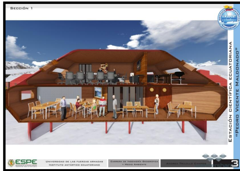
Figura 7. Corte Transversal Módulo Administrativo, Vivienda y Servicios
