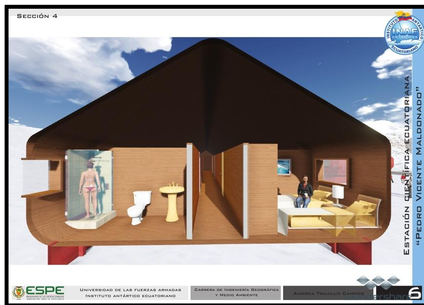
Figura 8. Corte Transversal Módulo Administrativo, Vivienda y Servicios
