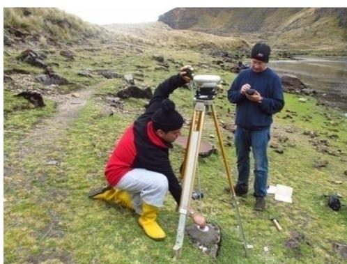
**Figura 78.** Midiendo la altura de la antena del GPS doble frecuencia (Kirby E. & Ortega M., 2013).
