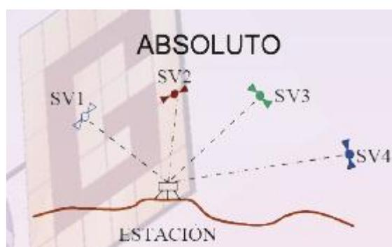
**Figura 32.** Posicionamiento Absoluto (Laboratorio de Astronomía Geodesia y Cartografía, n.d.)
