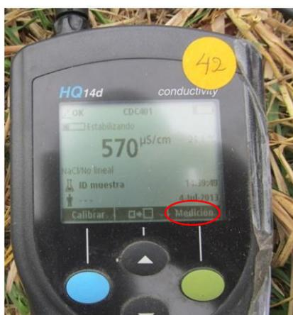
**Figura 80.** Conductivímetro marca HACH, modelo HQ14D (Ortega M., 2013)
