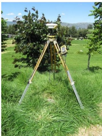
**Figura 71.** GPS doble frecuencia en el mojón del estadio de la ESPE (Ortega M., 2013)
