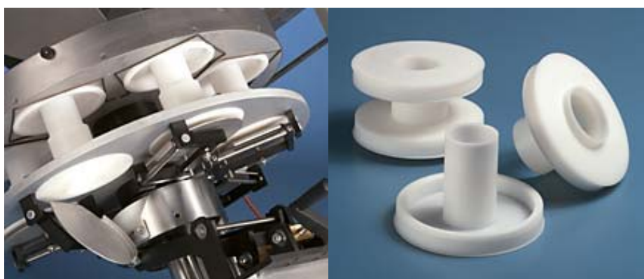
Figura 1.5. Dosificación mediante vasos volumétricos
