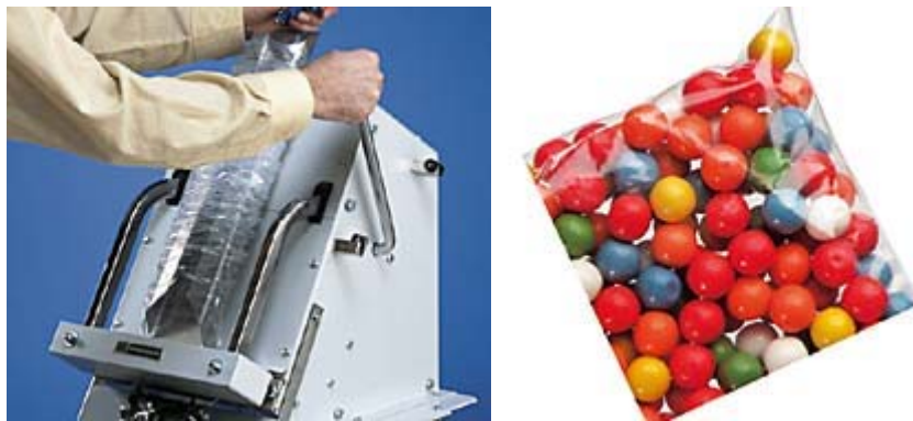
Figura 1.1. Empacadora manual con lámina preformada
