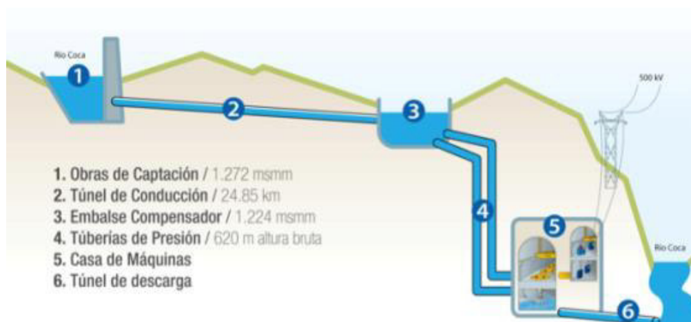
Gráfico No. 21: Tuberías de Presión
