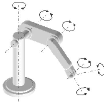
Figura 1.18: Distintos grados de libertad de un brazo de robot 19 .
