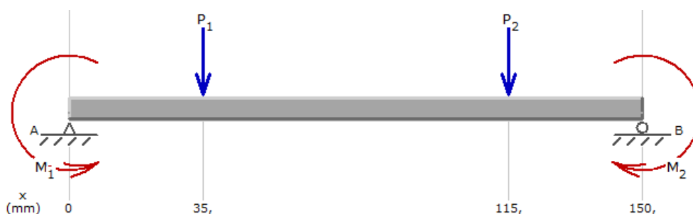
Figura 2.32: Diagrama de cuerpo libre en el canal en U 70 .
