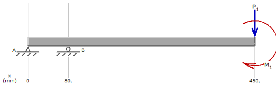
Figura 2.26: Diagrama de cuerpo libre en la guía del eje Z 63 .
