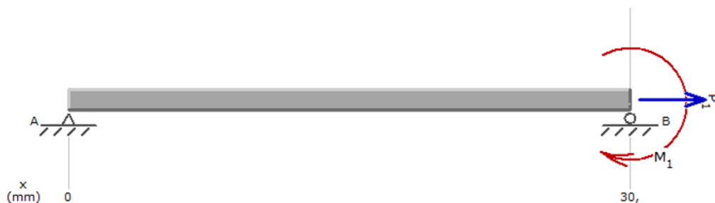
Figura 2.21: Diagrama de cuerpo libre de la lámina vertical 56 .
