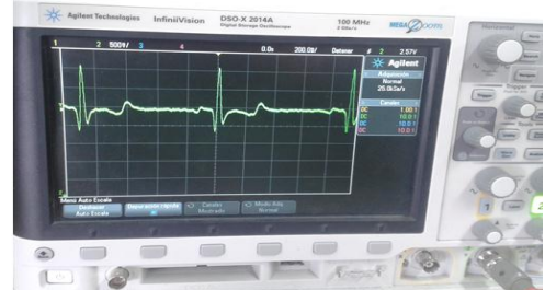
Figura 33: Señal obtenida del ECG implementado, mostrada en un osciloscopio.
