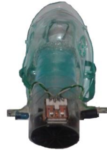
Figura 42: Mascarilla acoplada al Sensor de turbina e infrarrojo.
