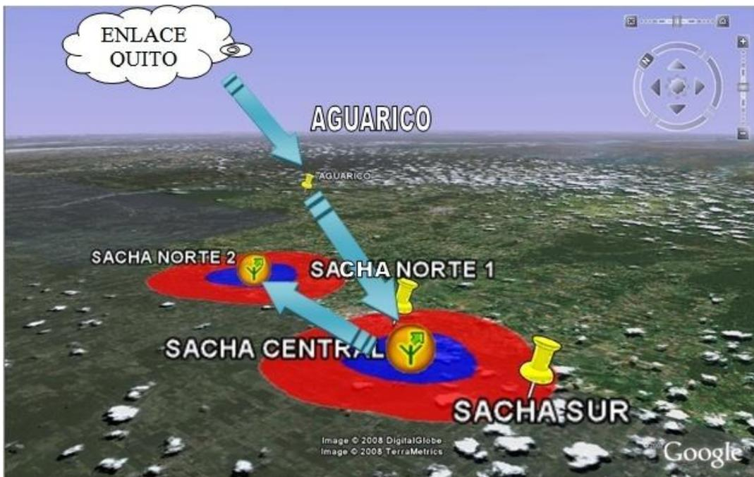
Figura. 5.1. Diseño de la Red.
