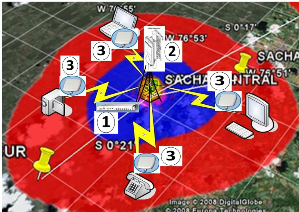
Figura 5.3. Diagrama de colocación de equipos Wi-Max
