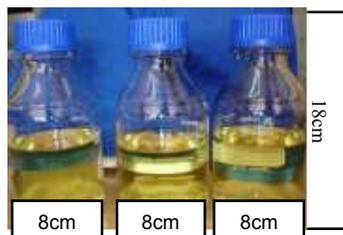
**Figura 2.9.** Frasco con caldo de cultivo YMB, donde se inoculó *Rhizobium* para ser aplicado al sustrato de las macetas con plántulas de fréjol (Cruz, 2009).
