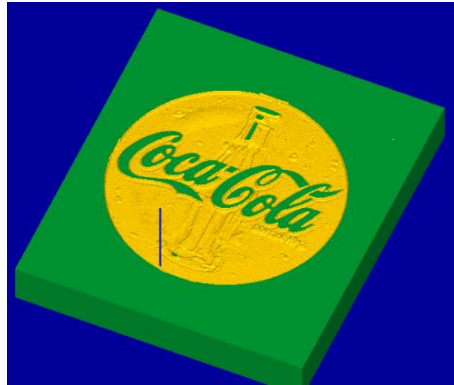
Figura 4. 37: Pieza 3D mecanizada con Art de Mastercam.
