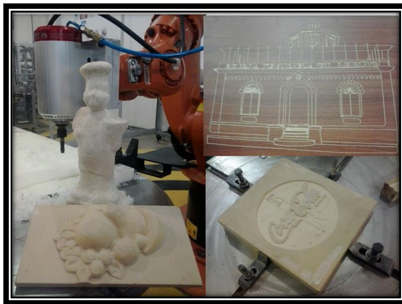
Figura 4. 77: Réplicas mecanizadas con el brazo robótico y el cabezal fresador.
