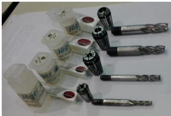
Figura 3. 2: Fresas y conos porta-herramientas ER 16.
