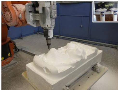
Figura 2. 3: Celda de manufactura PRODINTEC con robot para fresado.
