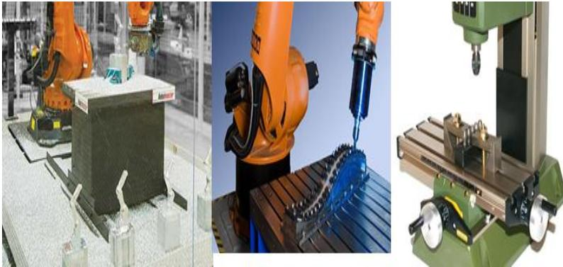
Mesas de trabajo de celdas de mecanizado con robot.
