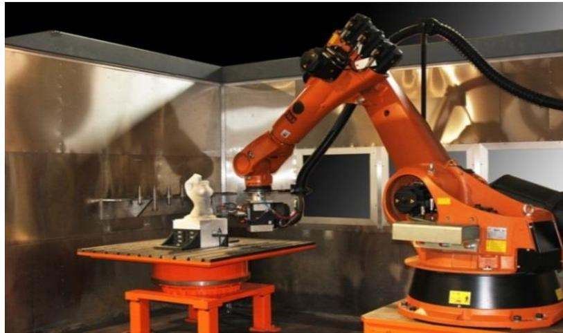
CELDA DE FRESADO CON BRAZO ROBÓTICO.
