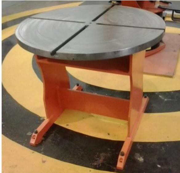
Mesa de trabajo para la celda de manufactura con robot.
