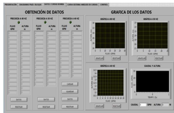
Fig. 6. Interface para la obtención de datos en los vectores a frecuencias de 60, 50 y 40 Hz.
