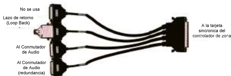
Figura. 2.18. Cable de conexión de la tarjeta sincrónica
