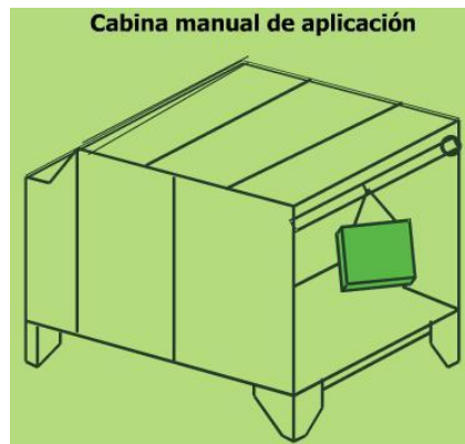
Fig. N° 3.3 Cabina para Aplicación Manual de Pintura en Polvo
