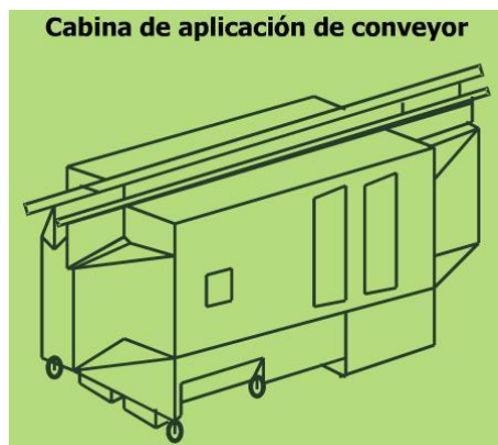
Figura N° 3.4 Cabina de Aplicación de Pintura en Polvo con un Sistema Conveyor
