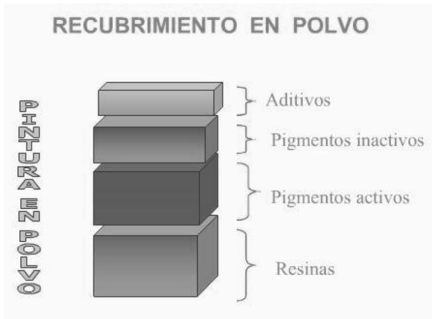
Figura N° 2.3 Componentes de la pintura en polvo
