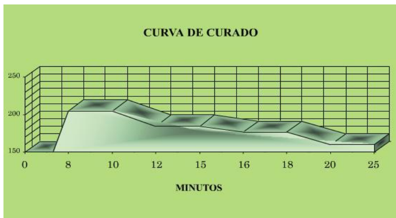
Figura N° 3.10 Curva de Curado Característica para Pintura en Polvo (eje x: tiempo (minutos), eje y: temperatura (°C))
