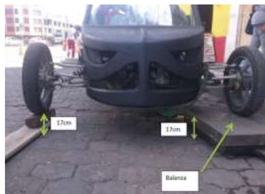
Figura 3.16. Medición del semieje delantero. Fuente: Propia
