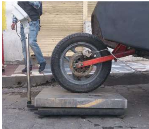
Figura 3.17. Medición del eje posterior Fuente: Propia
