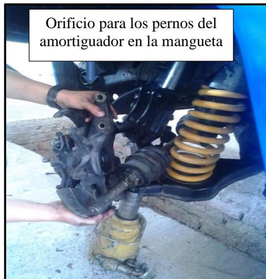
**Figura 4.6:** Instalación del amortiguador
