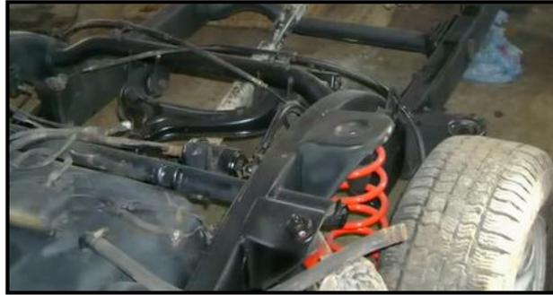
**Figura 3.19:** Resortes helicoidales
