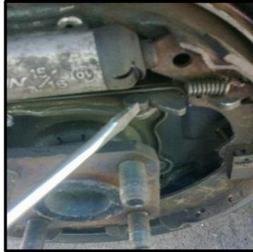
**Figura 4.42:** Regulación de las zapatas
