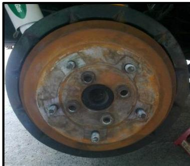
**Figura 4.43:** Instalación del tambor de freno
