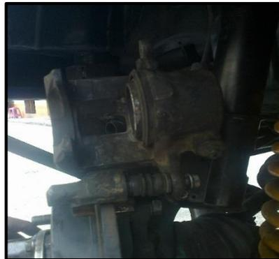
**Figura 4.31:** Instalación de la mordaza de freno
