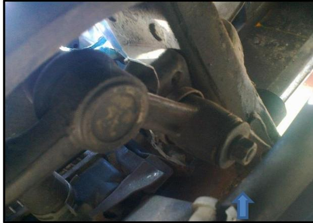
**Figura 4.16:** Instalación del reenvío
