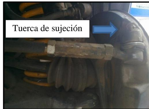
**Figura 4.18:** Instalación del terminal en la mangueta
