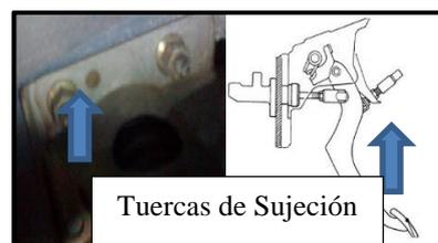
**Figura 4.23:** Instalación del servofreno
