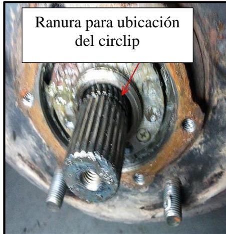
**Figura 4.4:** Instalación del circlip
