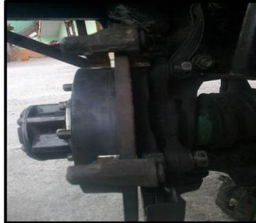
**Figura 4.30:** Instalación de la pinza de sujeción
