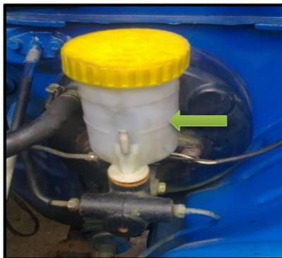
**Figura 4.46:** Nivel máximo en el depósito
