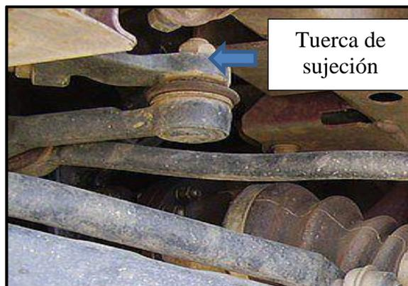
**Figura 4.17:** Instalación tuerca de sujeción
