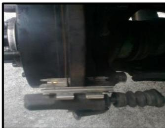
**Figura 4.32:** Instalación de los seguros guías
