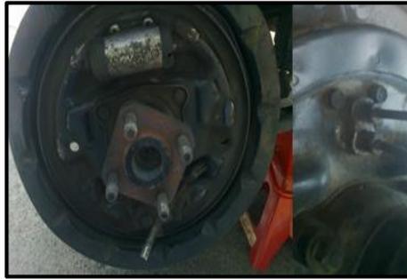
**Figura 4.36:** Instalación del cilindro de rueda
