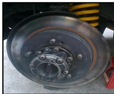
**Figura 4.29:** Instalación del disco de freno
