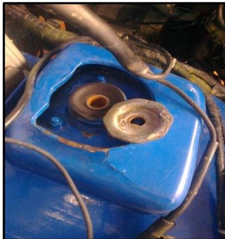
**Figura 4.5:** Base superior del amortiguador
