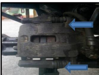
**Figura 4.34:** Instalación de los pernos de sujeción de las mordazas
