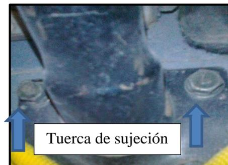
**Figura 4.19:** Instalación inferior columna de dirección
