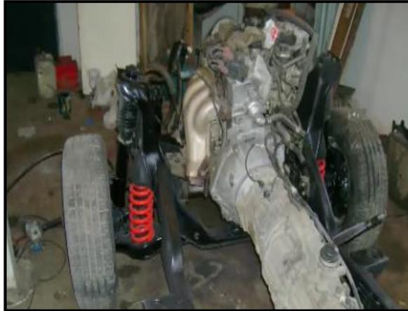
**Figura 3.9:** Sistema de suspensión McPherson
