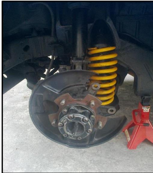
**Figura 4. 8:** Sistema de suspensión delantera
