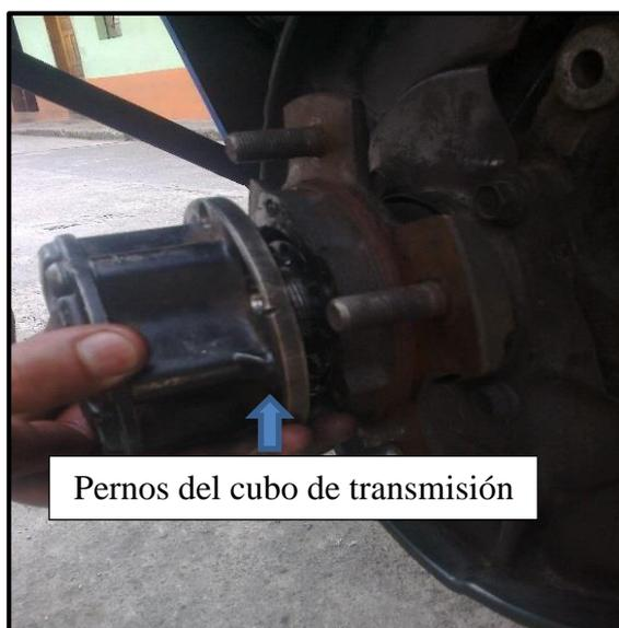
**Figura 4.7:** Instalación del cubo de transmisión
