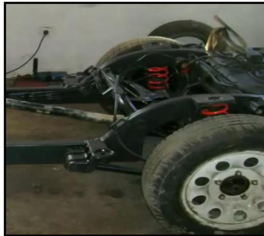
**Figura 3.16:** Sistema de suspensión de eje rígido
