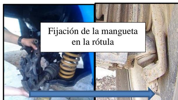
**Figura 4. 2:** Instalación de la mangueta de rueda
