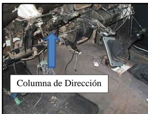
**Figura 4.21:** Columna de dirección completamente colocada
