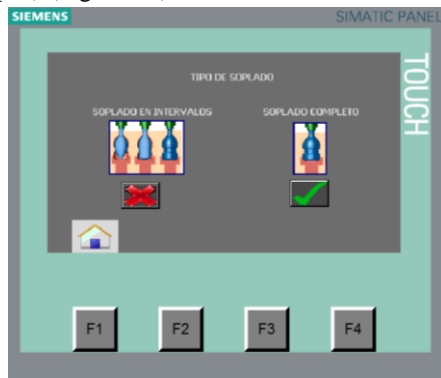
Figura 11. Ventana del tipo de soplado.
