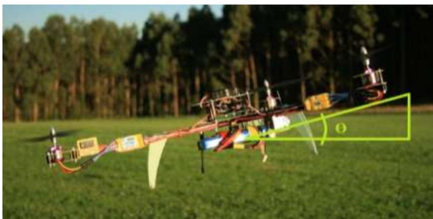
**Figura 1.3. Ángulo de Ataque para el desplazamiento de un Multicóptero.<sup>2</sup>**
