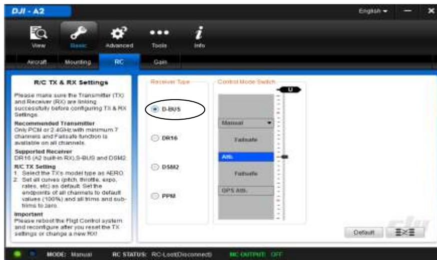
Es importante saber que se pueden dar casos en que no se necesite el receptor de la radio ya que se puede configurar al controlador de vuelo como receptor y funcionar con normalidad.
