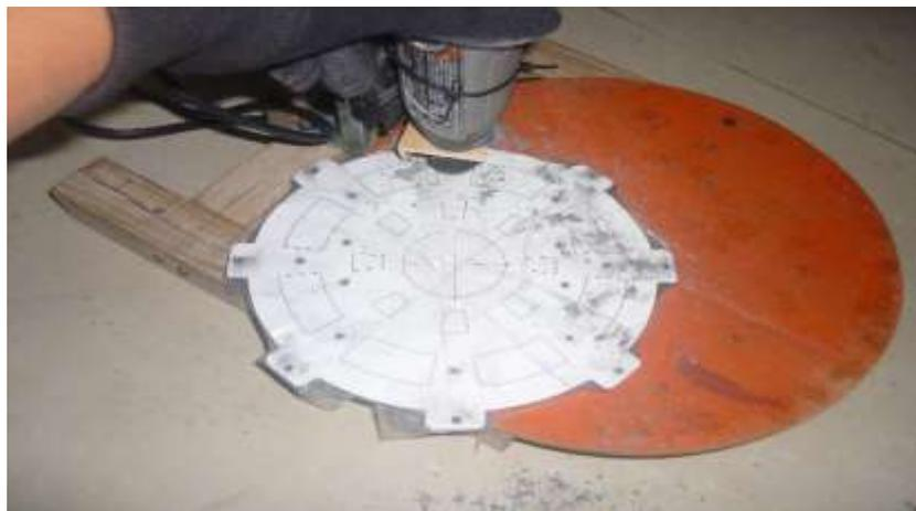
Ensamblaje de la estructura del octocóptero.
