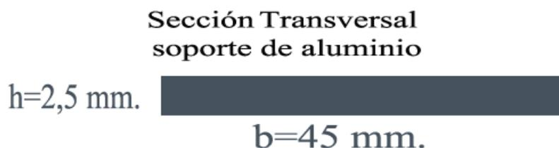
**Figura 2.16. Sección transversal rectangular del soporte de aluminio.**
