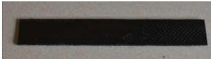
**Figura 3.4. Fibra de Carbono Endurecida y sacada del molde.**
