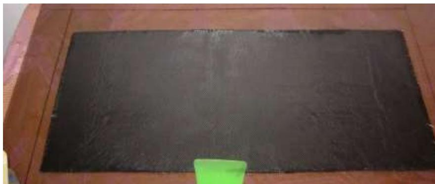
**Figura 3.15. Disposición de la fibra de carbono en una superficie lisa.**
