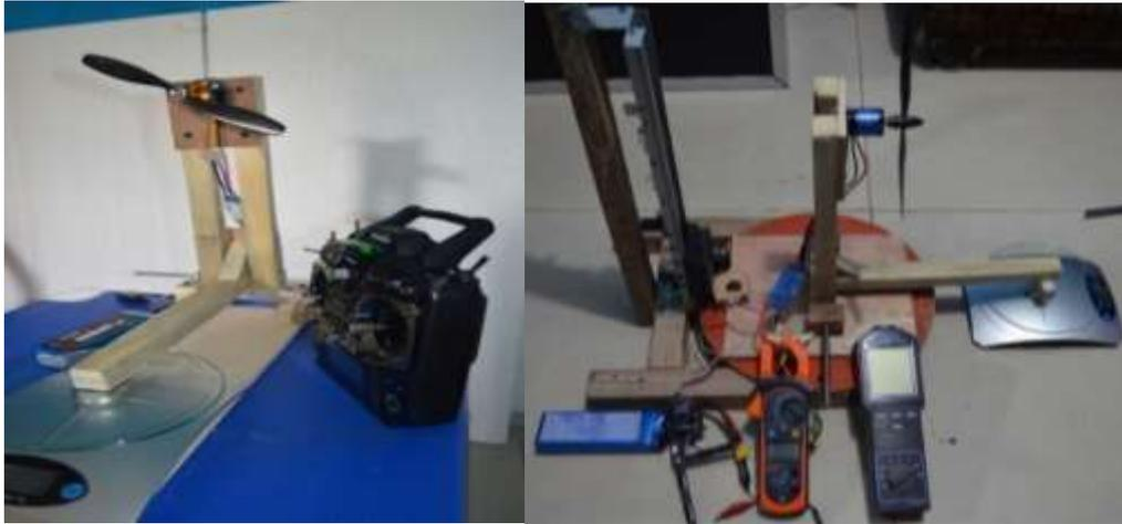
**Figura 3.19. Funcionamiento del Sistema de Pruebas de Empuje.**
