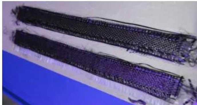
**Figura 3.3. Fibra de carbono lista para el siguiente paso.**
