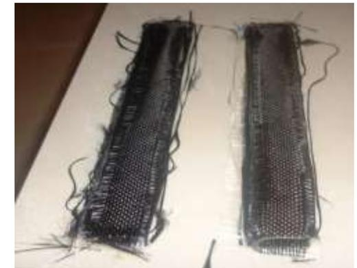
**Secado.-** Por otro lado respecto al tema del secado, el tiempo de curación o secado tarda 24 horas a temperatura ambiente, existen otros métodos para el secado como pistola de calor, secador, o lámparas de calor, todos estos métodos aceleran el proceso de secado, todos son permitidos y todos mejoran la velocidad del curado de la resina.
