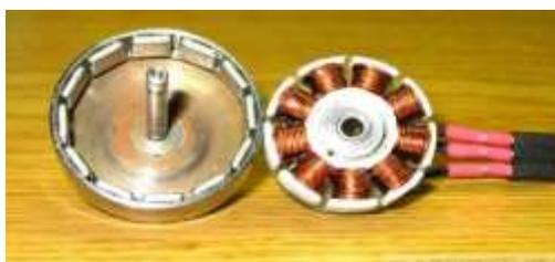
**Figura 1. 6 Motor sin Escobillas.**<sup>5</sup>
