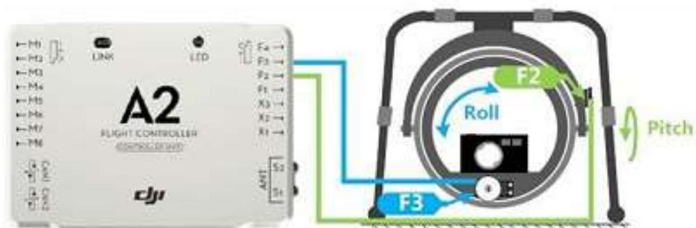
**Figura 2.46. Diagrama de Conexiones Gimball.**
