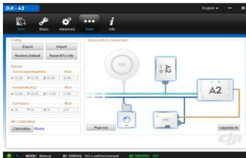
Una vez concluidas las calibraciones el software indica la siguiente alerta debido a que físicamente no se ha calibrado la IMU
