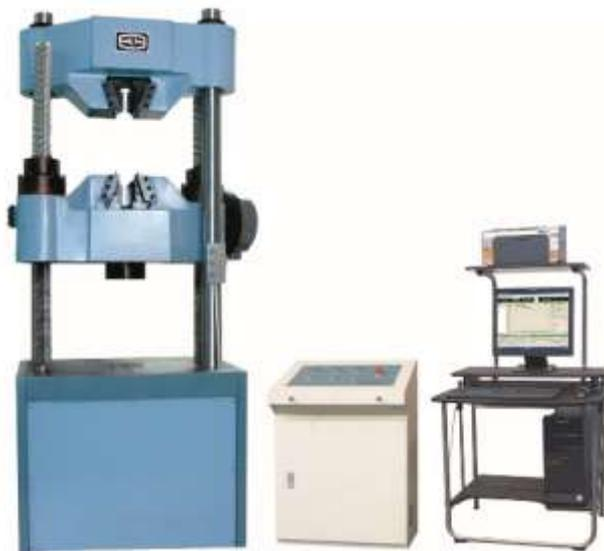
**Figura 3.6. Maquinaria para pruebas de tracción y flexión.**<sup>39</sup>
