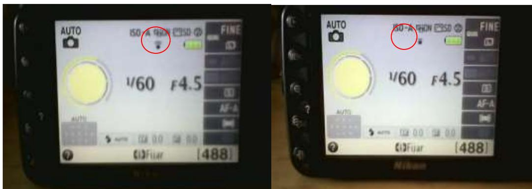
**Figura 3.35. Indicador de funcionamiento Eye Fi.**
