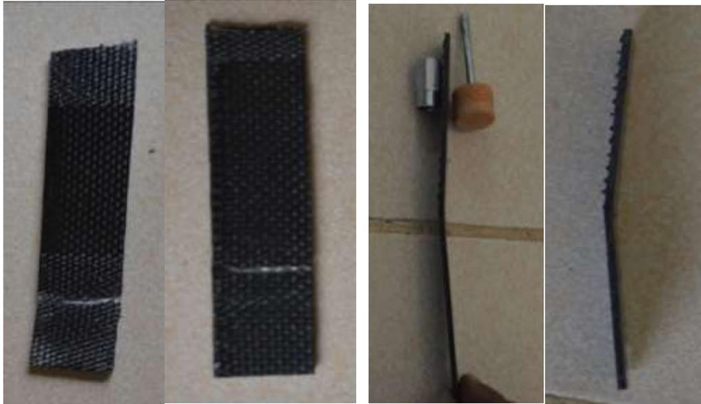
**Figura 3.8. Probetas deformadas debido a las pruebas de tracción y flexión.**
