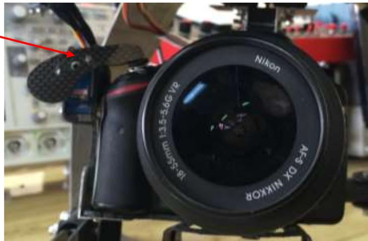
**Figura 3.33. Disparador acoplado a la cámara.**
