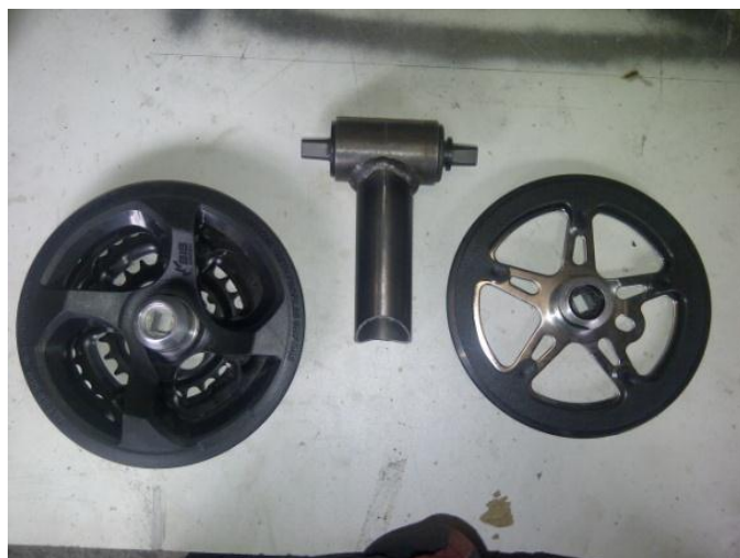
Figura 3. 8.- Sujeción del eje intermedio de la transmisión.
